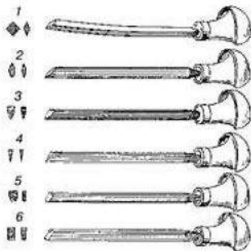
Рис. 228. Образцы форм стихелей для торцовой гравюры: сверху вниз: 1, 2 — грабистихели; 3, 4 — тонстихели; 5, 6 — болтстихели
